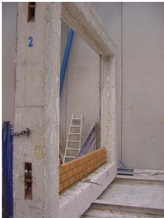
**Foto 1: Construcción de la primera fábrica de LHD de 8 cm**
