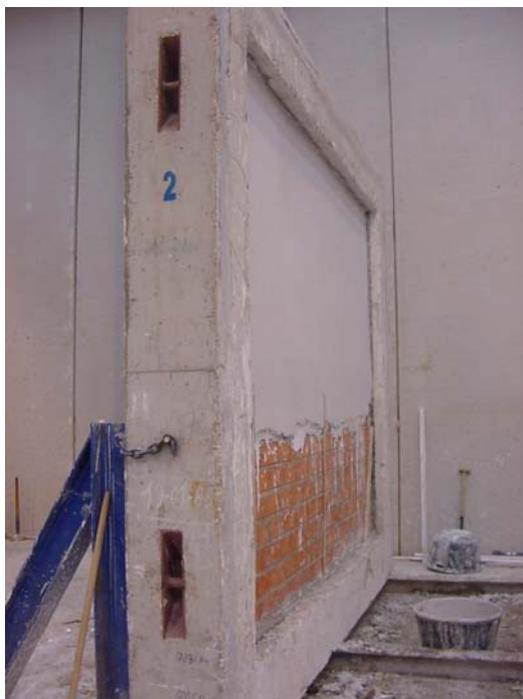
**Foto 3:** Aplicación del revestimiento de yeso en la fábrica de LHD de 8 sobre banda perimetral de poliestireno expandido elasticado
