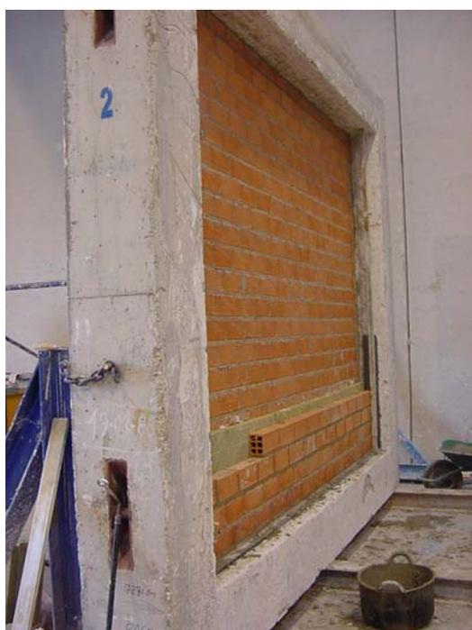
**Foto 2: Construcción de la segunda fábrica de LHD de 8 sobre banda perimetral de poliestireno expandido elastificado**
