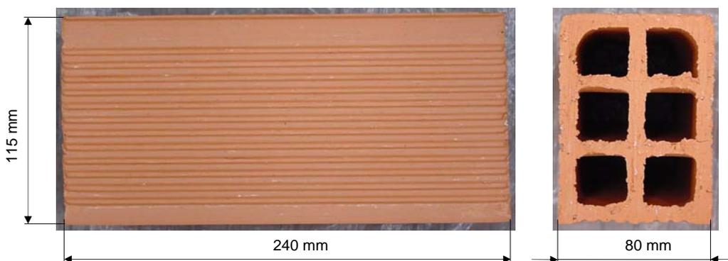
**Figura 2:** Dimensiones medidas del ladrillo hueco doble de 8
